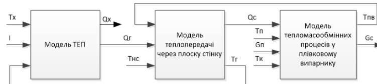
Рисунок 1 – Структурна схема математичної моделі термоелектричного плівкового випарника як об'єкту керування
